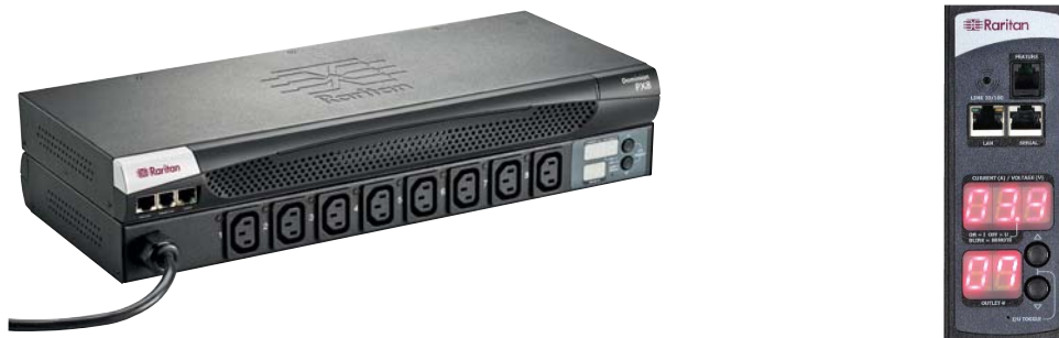
Beispiele intelligenter PDUs: Der Null-U-LEDLeistungsmesser (rechts) verdeutlicht die Messung auf Stromanschlussebene; in diesem Beispiel werden an Buchse 7 3,4 Ampere gemessen.
