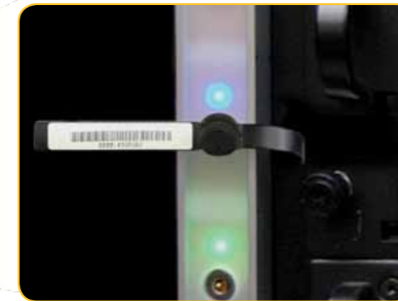
Asset Management Sensor (AMS) Anpassbare RGB-Farb-LED für jede einzelne HE
